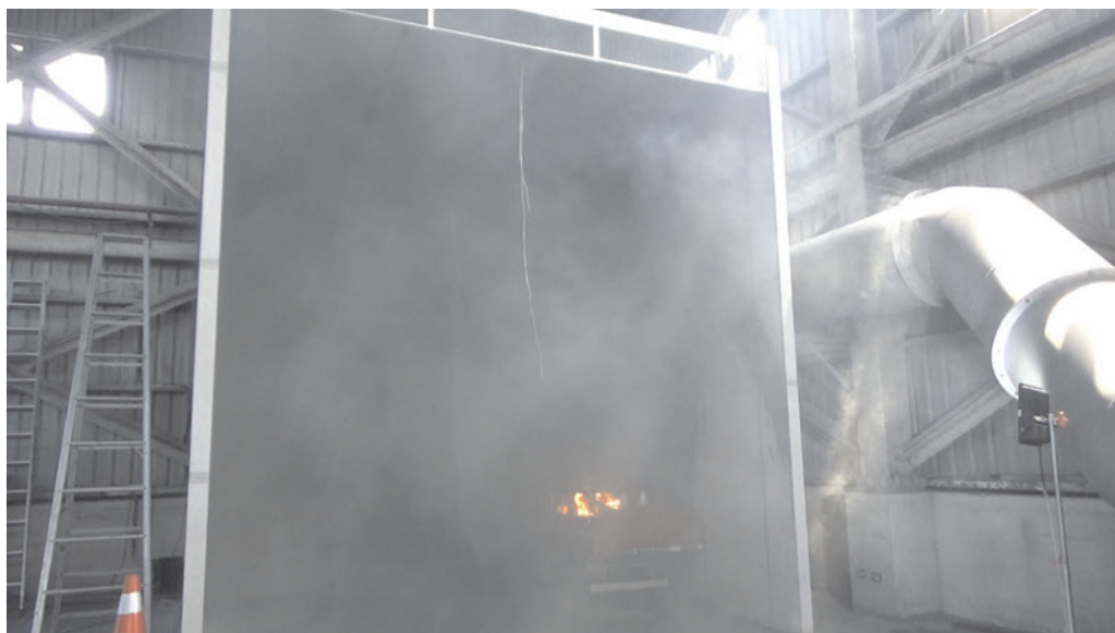
圖 35 水道式設備放射時水滴粒子擾動煙層情形
