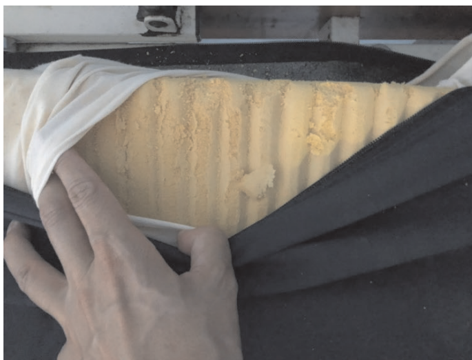
圖 14 實驗引火物：泡棉床墊
